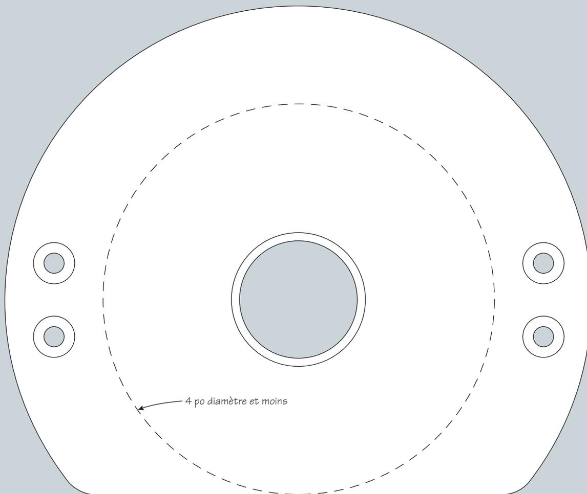
**Diamètre maximal du boîtier de la toupie compacte**
